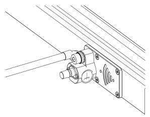
Fig. 136: Fully mounted equipotential bonding cable
