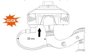
Fig. 187: Attach angled blade receptacle
